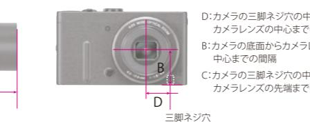
D: カメラの三脚ネジ穴の中心からカメラレンズの中心までの間隔
