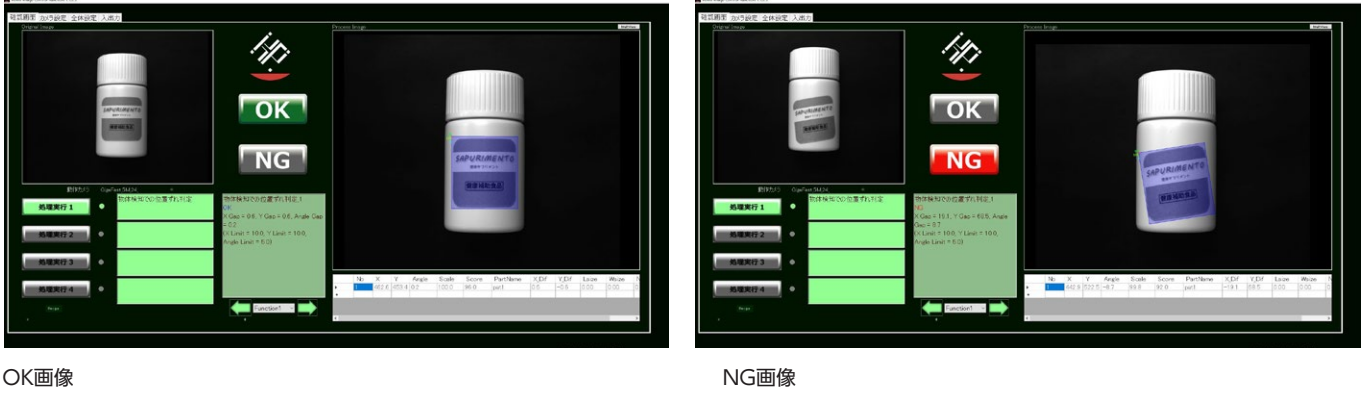
ラベルの向き、角度が正しく貼り付けられているか判定
