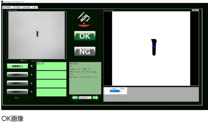
ワークの長さを計測し、適合しているかどうかを判定
